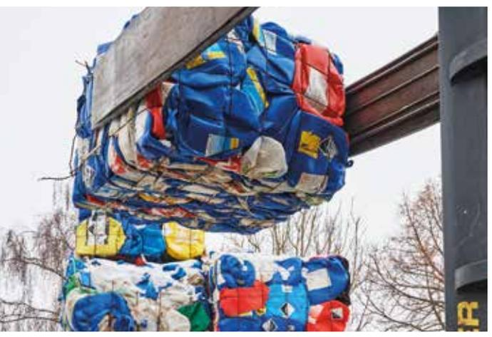
Das Rohmaterial kommt bei InnoPlastics in den verschiedensten Qualitäten in Ballen gepresst an. Das Ausgangsmaterial wird zerkleinert, mehrfach gewaschen und in verschiedenen Anlagen aufwändig getrocknet, bevor es zu neuem Regranulat extrudiert wird. Über unsere Teilnahme am Energiesparprogramm achten wir auch während des Recyclingprozesses darauf, keine Energie zu verschwenden.
