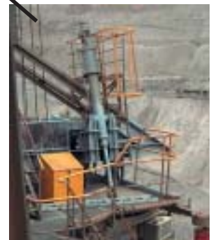
Niveauregulierung der Fahrerkabine an Braunkohlebaggern
